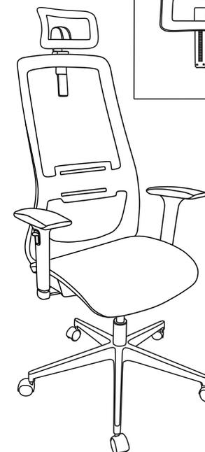
Примечание: Шаг 1. Снять защитный колпачок с газлифта, в случае его наличия.
